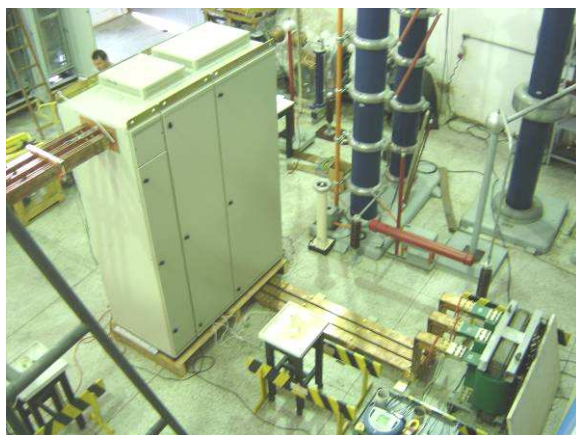
Fig.02 – QGBT no ensaio de elevação de temperatura em 3200 A.
