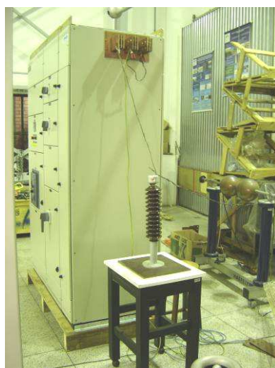
Fig.04 – QGBT no ensaio de impulso atmosférico
