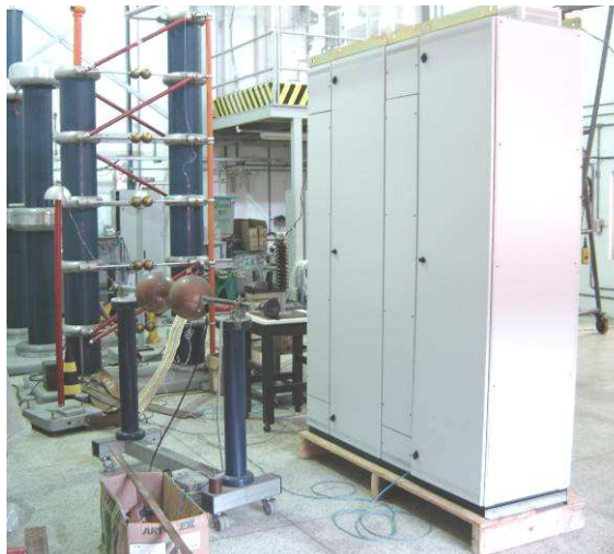
Fig.04 – CCM no ensaio de impulso atmosférico
